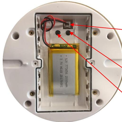
Connectez le connecteur Mâle sur le connecteur Femelle de la sirène. Le fil rouge est à gauche du connecteur. Le flash rouge clignotera 4 fois.
