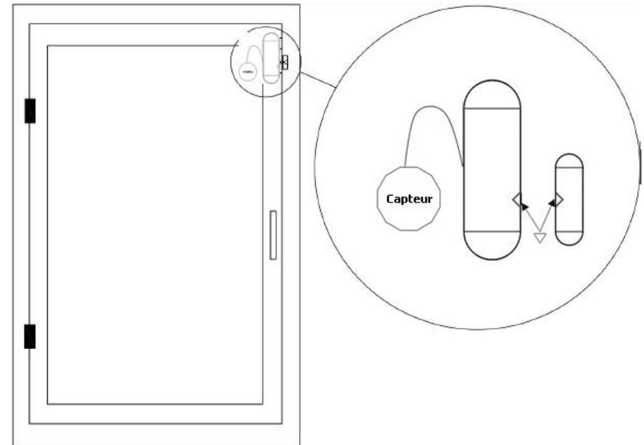
Le transmetteur et le capteur de choc doivent être installés sur la fenêtre, côté ouvrant. L'aimant doit être posé sur l'huissierie de la porte. Les 2 triangles doivent être face-à-face et écartés de moins de 1 cm (Fig. 2). Enlever le film rouge derrière le capteur pour le coller. Le transmetteur et l'aimant pourront être vissés ou collés (adhésifs fournis).
